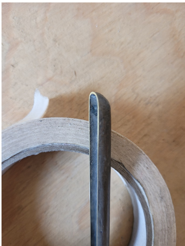
Photo 17 : Profil des gouttières de trompette grand orgue.
