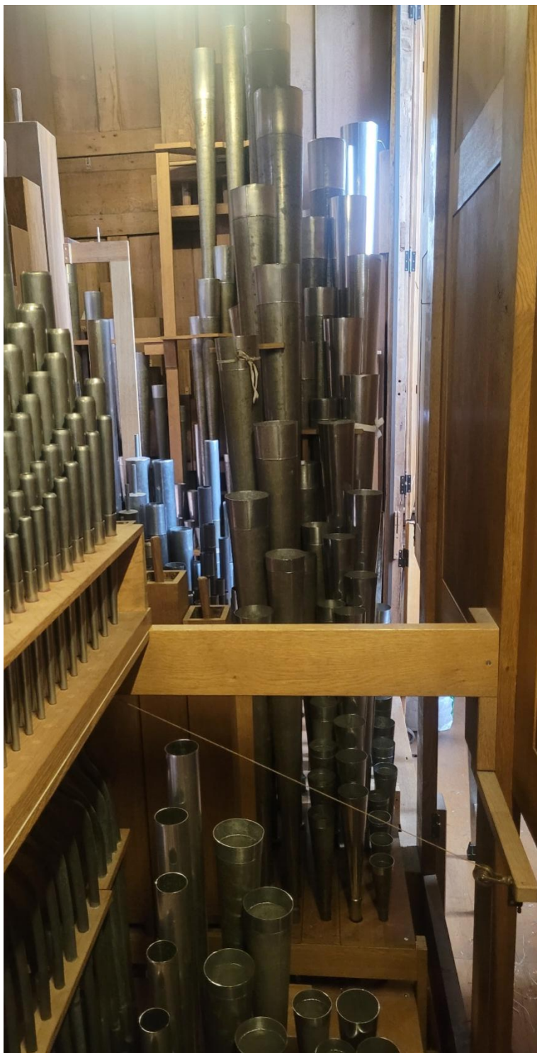
Photo 13 : Les rallonges sur les résonateurs des anches.
