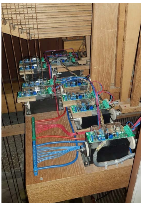
Photo 8 : Carte électronique et câblage neuf.
