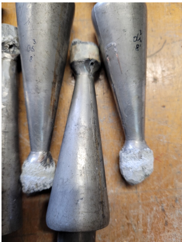
Photo 15 : Corrosion importante des noyaux.
