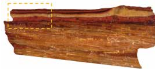
Vue en coupe d'un échantillon de peinture de l'orgue de Tarascon. On distingue les différentes couches.
