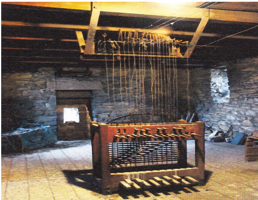
Le clavier coup de poings et la tringlerie
